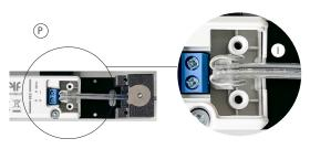
Die einfach isolierten Litzen müssen sich innerhalb des Betriebsgerätegehäuses befinden – der Kabelmantel muss für die sichere Zugentlastung zwingend bis ins Gehäuse geführt werden!
