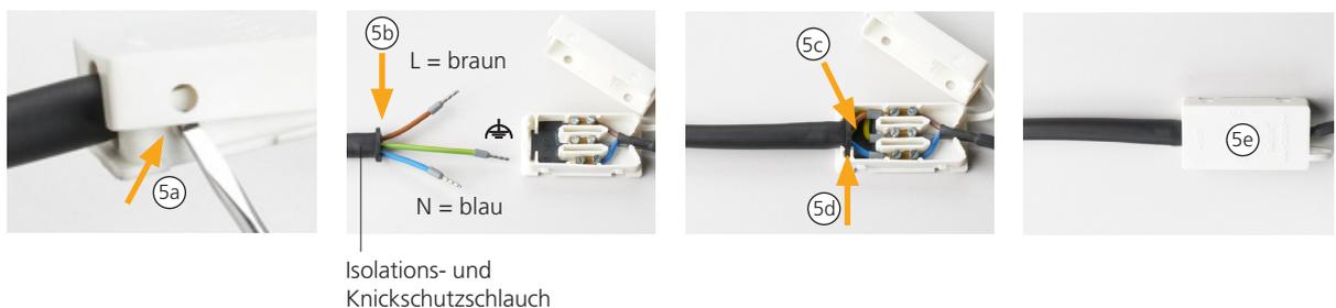
Isolations- und Knickschutzschlauch
