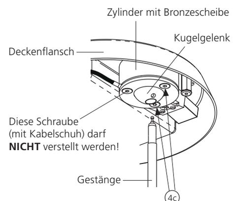
Diese 2 Schrauben entsprechend lockern oder anziehen.
