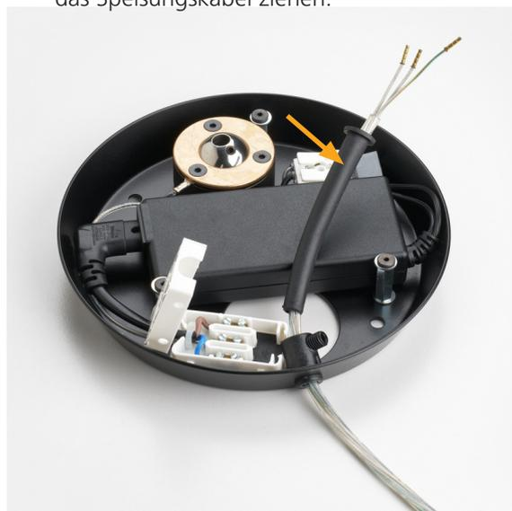
Innerhalb der Leuchte muss zwingend eine doppelte Isolation der Einspeisung sichergestellt sein, gegebenenfalls zusätzliche Isolationsschläuche verwenden!
