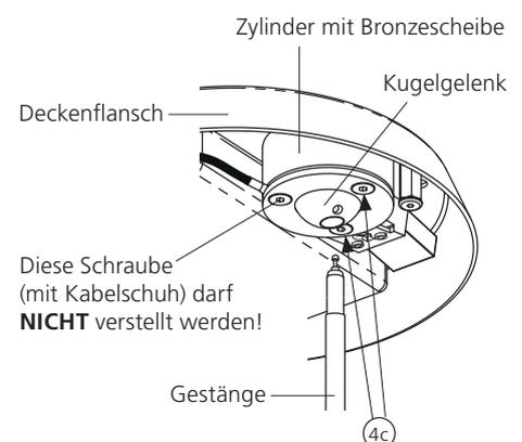
Diese 2 Schrauben entsprechend lockern oder anziehen.
